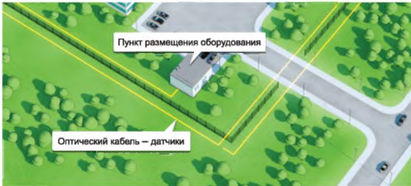
Рис.5 На рисунке изображён фрагмент 3D карты местности со схемой размещения оборудования и кабеля-датчика.
