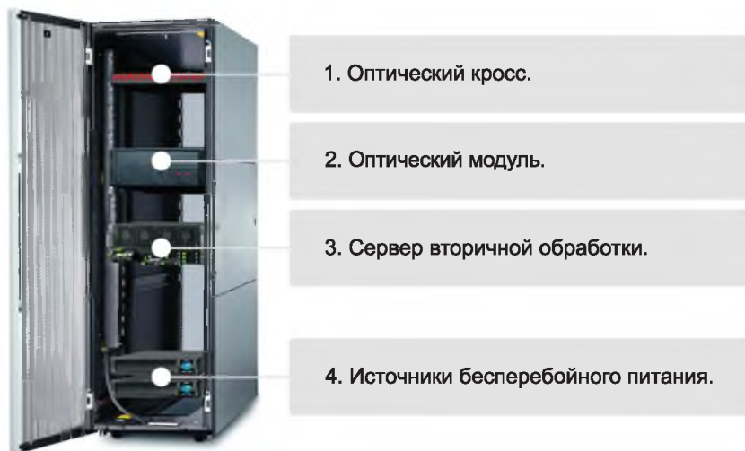
Рис.1 Типичная серверная стойка, оснащенная комплексом охраны.
